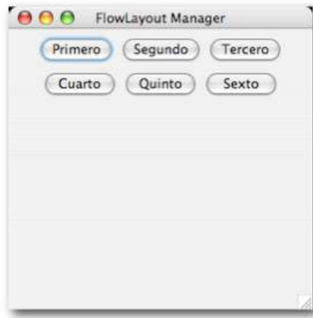
Figura 11.1: Colocación de Componentes con FlowLayout .
