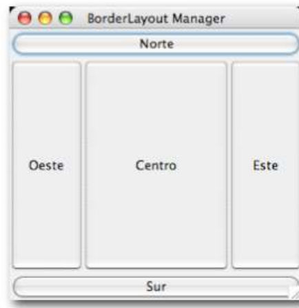
Figura 11.2: Colocación de Componentes con BorderLayout.
